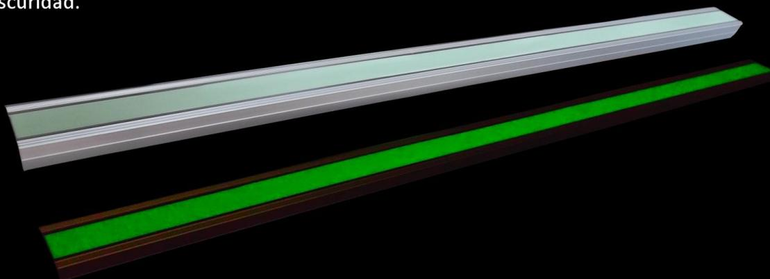
Se encargan muy rápidamente (1 minuto basta para una luminancia de 30 minutos) gracias a la luz eléctrica o natural. re-emiten la energía almacenada en forma de luz en la oscuridad. La cantонера es compuesta de un soporte de aluminio y de un inserto plástico a la vez fosforescente y anti deslizamiento.
