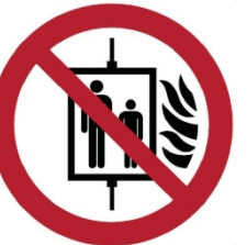
P020 - Prohibido utilizar el ascensor en caso de incendio
