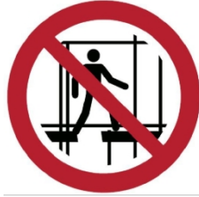
P025 - Prohibido utilizar andamios inc.
