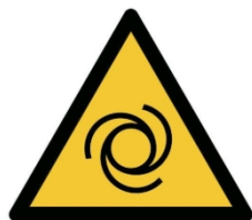
W018 - Peligro: arranque automático
