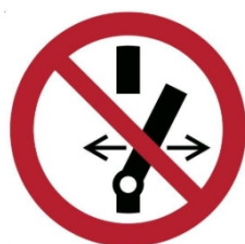
P031 - No modifique la posición del interruptor
