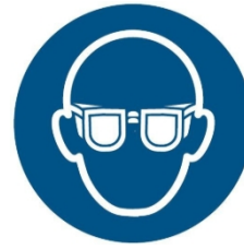
M004 – Uso obligatorio de gafas de protección
