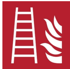
F003 – Escalera contra incendios
