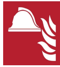
F004 – Equipo completo de extinción de incendios
