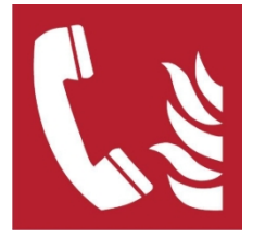
F006 – Teléfono para usar en caso de incendio
