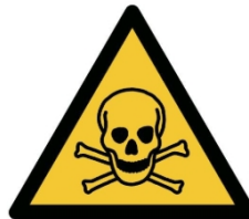
W016 - Peligro: materiales tóxicos
