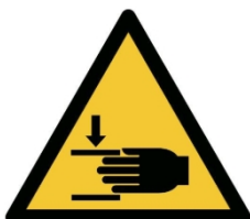
W024 - Peligro de aplastamiento de las manos
